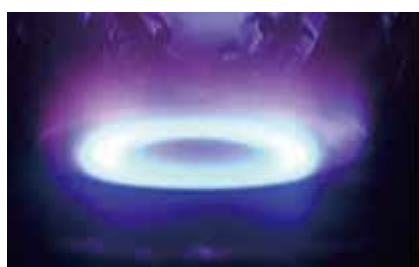
図1 カーボンターゲット上での放電状況
